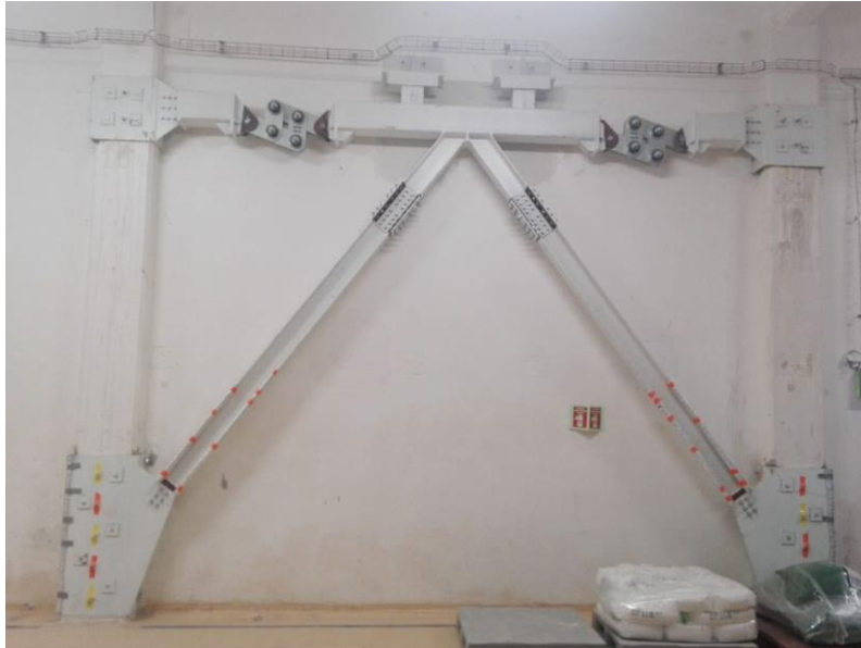
Şekil 4. Ters V tipi montajı tamamlanmış sürtünme tipi sönümleyici
